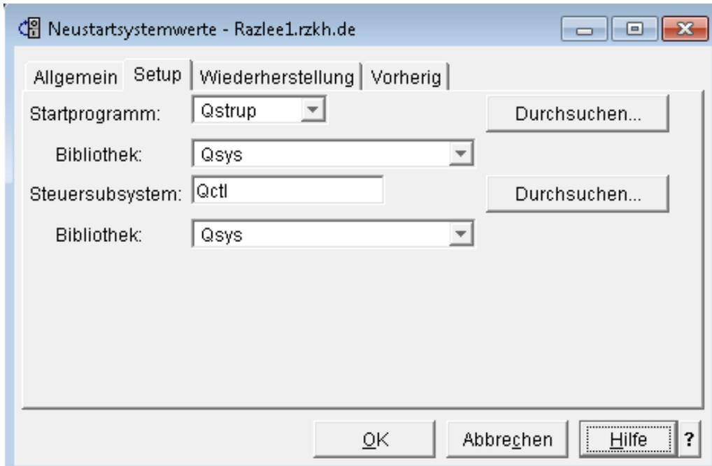
Auf der Seite „Setup“ können Sie sich anzeigen lassen oder angeben, mit welchem Programm das System gestartet wird. Auf dieser Seite können Sie außerdem das Steuersubsystem auswählen. Das Steuersubsystem ist das erste bei einem Neustart des Systems gestartete Subsystem.
